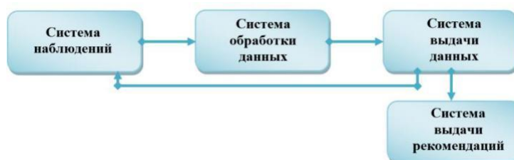
Рисунок 2 – Этапы технического мониторинга строительных объектов
